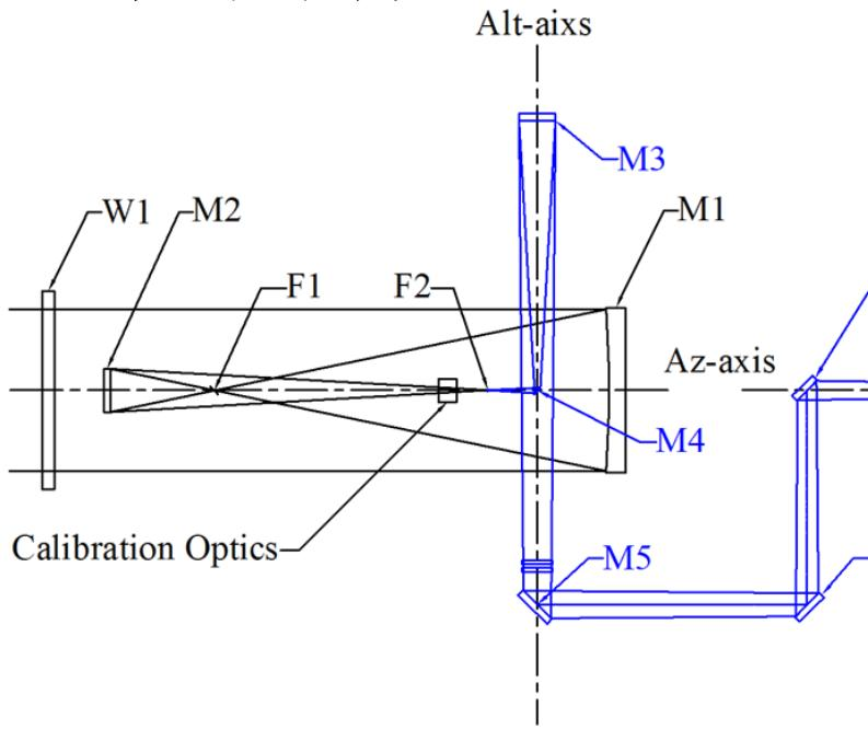
地平指向机构：主光路 + 折轴光路
