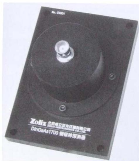
图 4.10 InGaAs/InP 探测器
